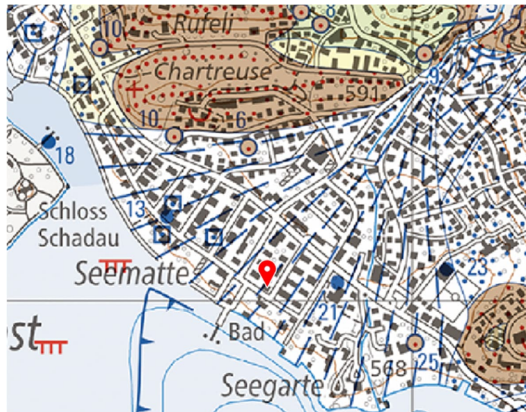
Abbildung 3 Geologische Karte des Projektstandorts Bachschuttablagerungen (Weiss mit blauer Schraffur), Molassefels (braun), Moränenablagerungen (gelb) und Hangschutt (Weiss mit blauen Punkten). Projektstandort rot markiert
